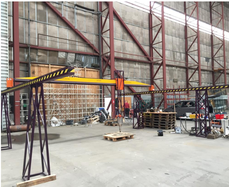
Anden Testprinter opsat og testet på Nordhavn sommer 2017 (print areal 8*8*1 meter).
