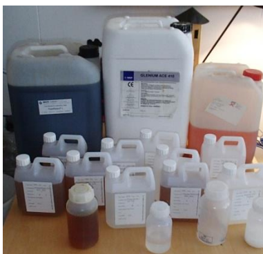
Udvalg af forskellige hjælpestoffer anvendt i forsøgene - Plastificering, viskositet (VMA), accelerator, retarder, skumdæper mv.
