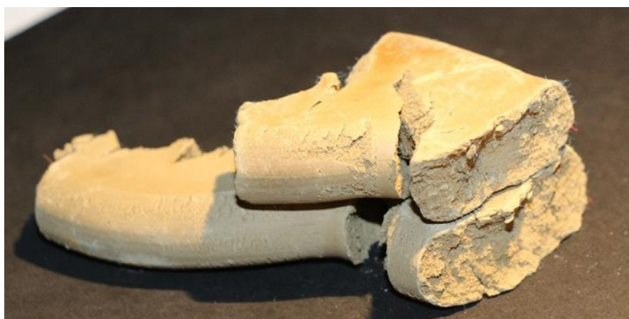
Eksempel på ekstruderede ler-”pølses”, hvor der er tilsat fibre for at reducere muligheden for svindrevner og for at gøre materialet formstabil. I det givne tilfælde er der ingen sammenhæng/binding mellem de enkelte pølses/lag
